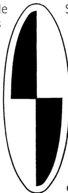
Sur le territoire de la ville, cette détection est effectuée à l'aide de boucles de détection installées sous le pavage. Les usagers du réseau routier municipal remarqueront au cours des prochaines semaines le pictogramme ci-contre peint sur le pavage au-dessus de ces boucles de détection.
